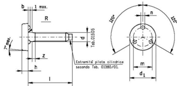
**Esempio di designazione:** 1/40358/10 – Tab. 10453/05 – Vite SDPR con estremità pilota M6 x 35 – Mat. R50 SD Stab.
